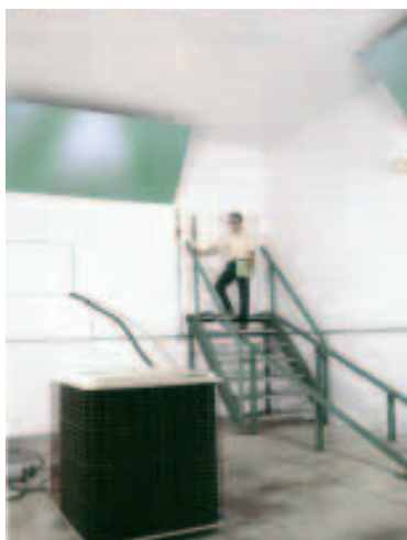
Chambre réverbérante pour tester un module de réfrigération
