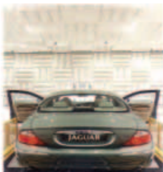
Chambre acoustique équipée de dièdres Metadyne®
