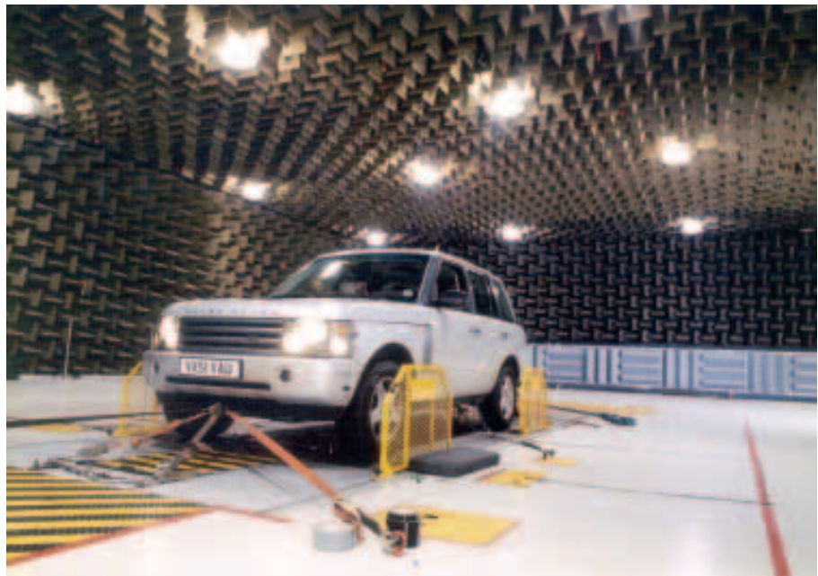
Salle équipée de dièdres en mousse et de ventilation intégrée en dièdres métalliques Metadyne®
