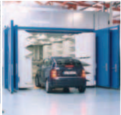
Chambre semi-anéchoïque en cabine
